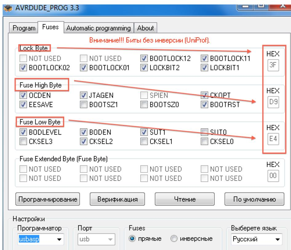
При прошивке фьюзов другими программами, в общем случае необходимо установить LockByte – 3F, Fuse High Byte – D9, Fuse Low Byte – E4. При последующих обновлениях программы контроллера прошивка фьюзов больше не требуется.
